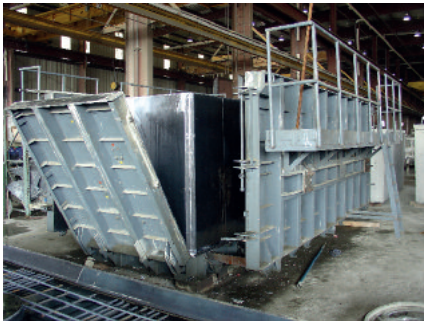
5, 6, 7. Proces rozformowywania bez konieczności usuwania części rdzenia.
